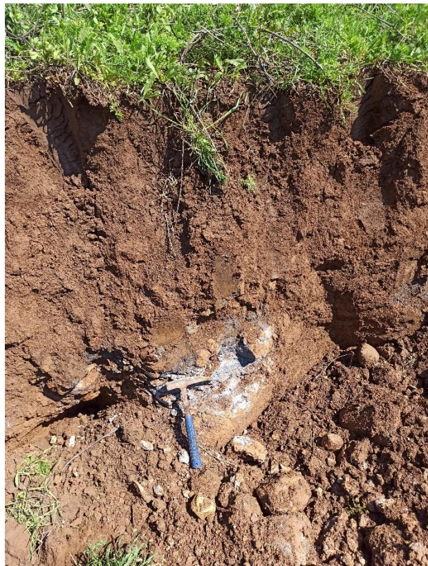
איור 7: בור שנחפר ע"י באגר, חרסית בעובי 1 מטר מעל בזלת בלוייה, צולם 500 דרומית לשטח
